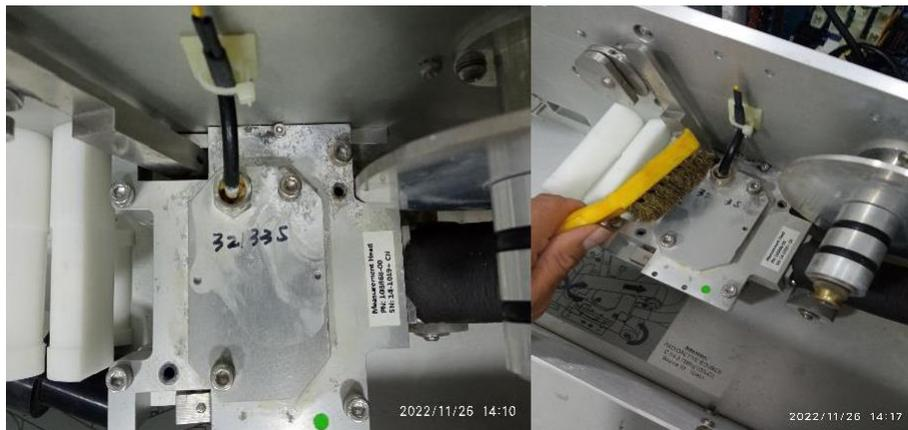
*Ilustración 14. Limpieza externa de la cámara de radiación Beta.*
