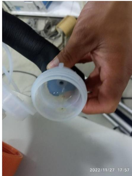
*Ilustración 76. Residuos de agua encontrados en la línea neumática en el porta filtro de partículas.*
