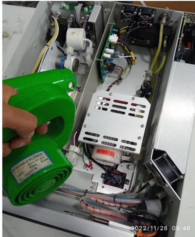
*Ilustración 87. Limpieza general del analizador Sutrom.*
