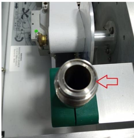
*Ilustración 6. La boquilla no tiene el O-ring de sellado.*
