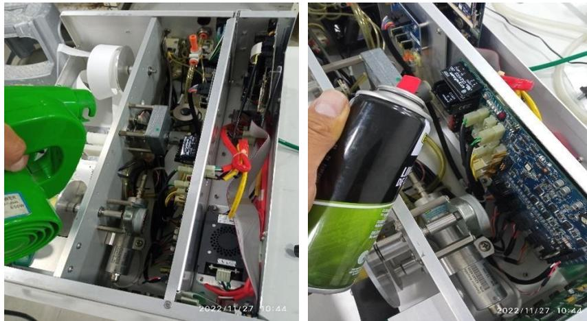
*Ilustración 57. Limpieza general del equipo y limpieza de tarjetas electrónicas.*
