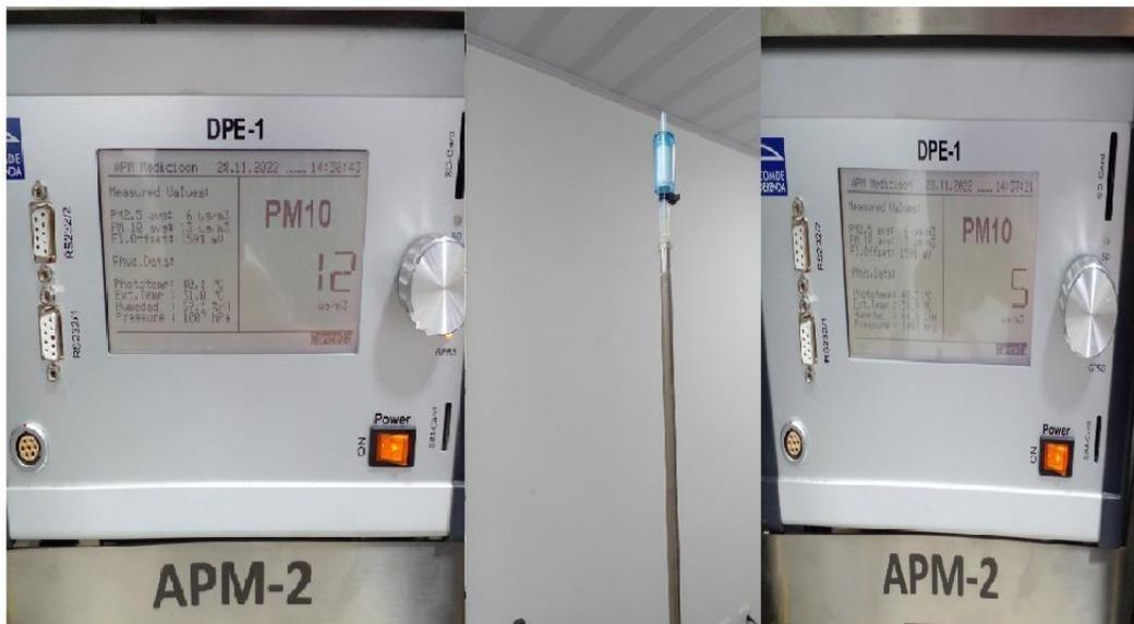
Ilustración 122. Se observa la respuesta positiva del monitor de partículas al verificar el offset. Bajó de 12 µg/m³ a 5 µg/m³.
