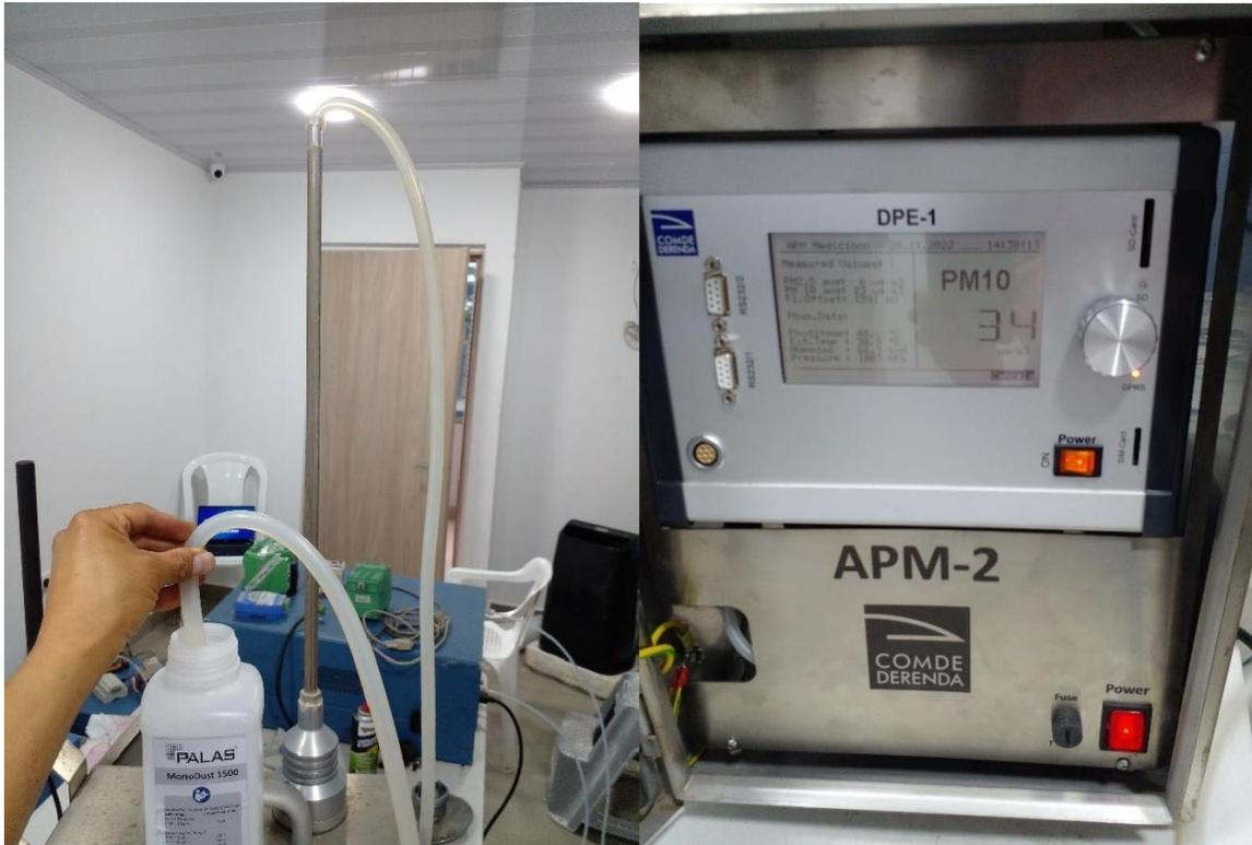
*Ilustración 123. Verificación con material de referencia Mono Dust. Respuesta positiva del monitor de partículas.*
