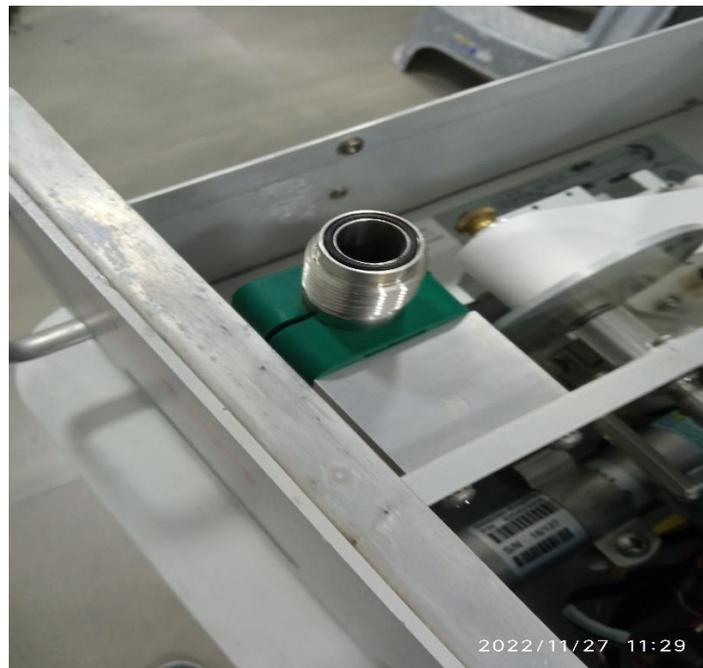
*Ilustración 70. Verificación de O-Ring y boquilla.*
