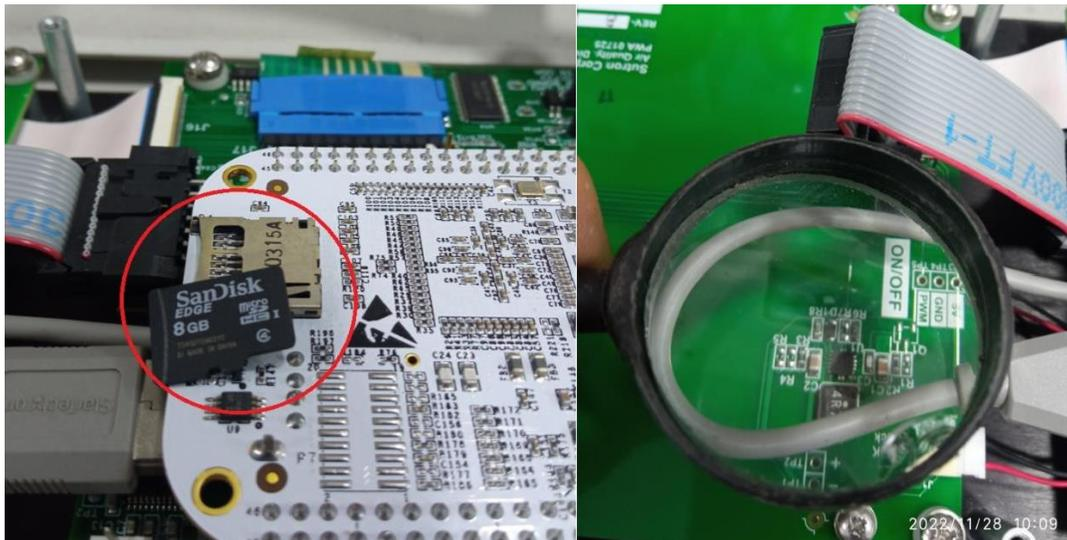
*Ilustración 94. Revisión de la memoria física y verificación de los fusibles de la tarjeta.*
