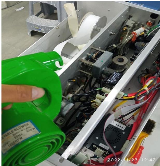
*Ilustración 128. Limpieza general y revisión de las tarjetas electrónicas.*
