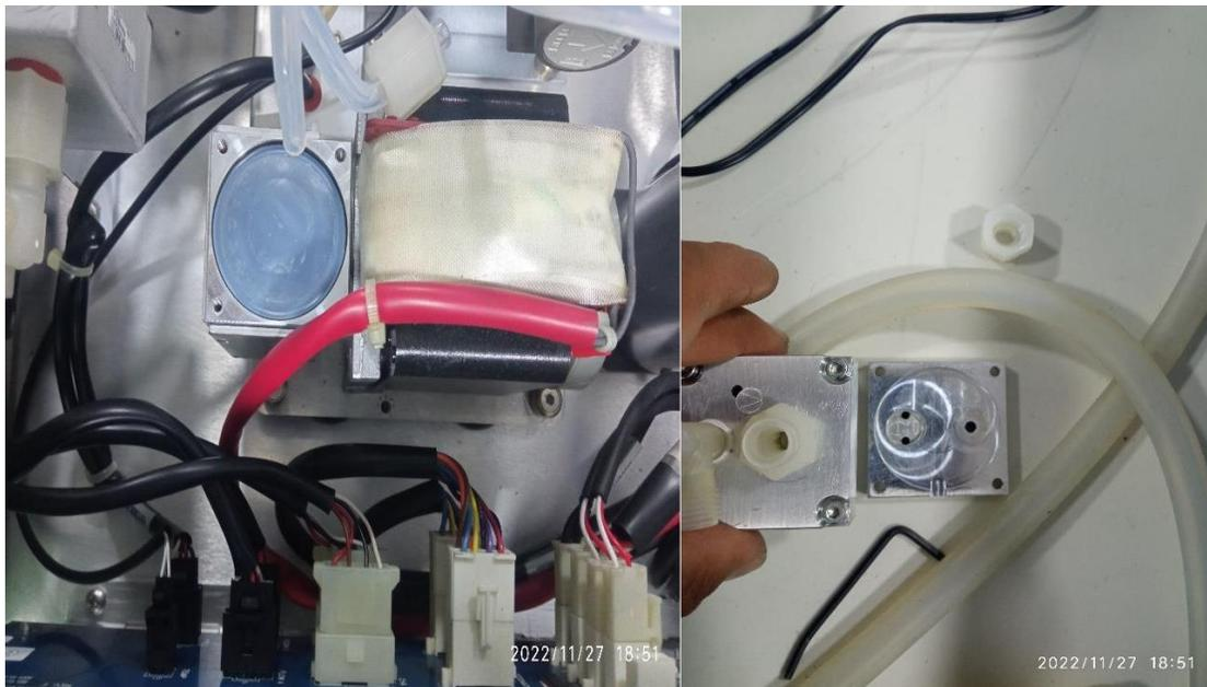
*Ilustración 79. Revisión del embolo de la bomba de succión.*
