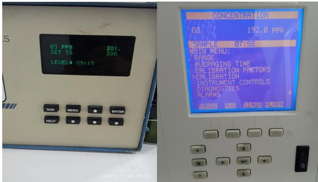
*Ilustración 144. Verificación y respuesta del analizador al punto de span con el calibrador por dilución.*
