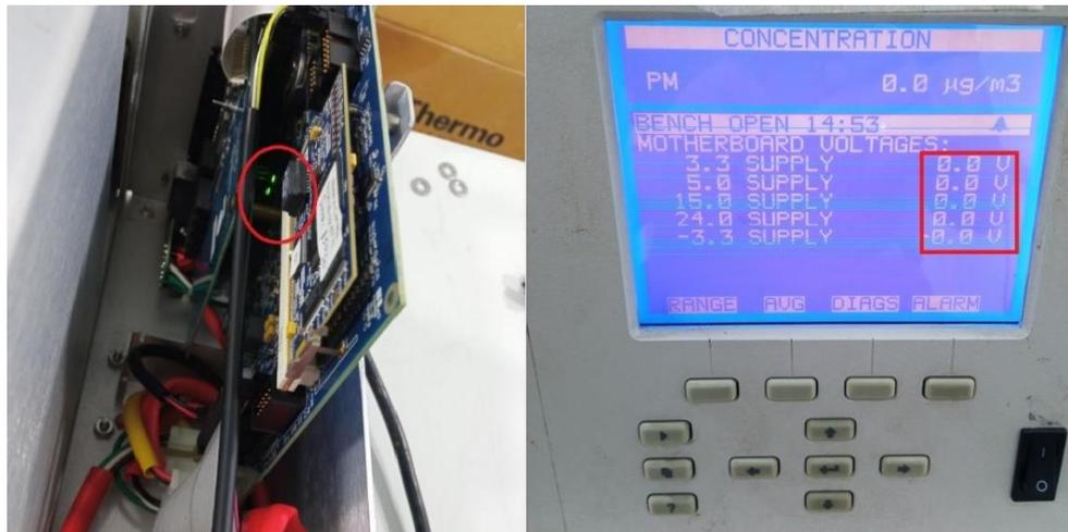
*Ilustración 24. Izquierda se observa que la board tiene voltaje de operación. A la derecha se observa que la board no reconoce voltajes ni señales.*
