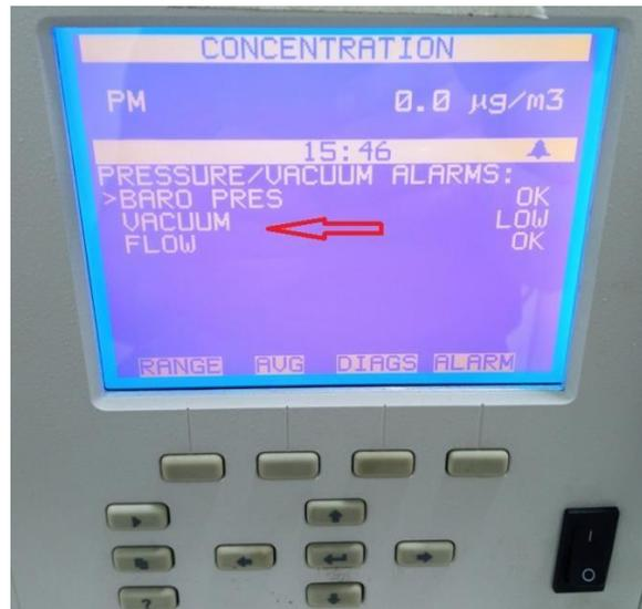
*Ilustración 51. Verificación de señales de los sensores de presión barométrica y vacío*
