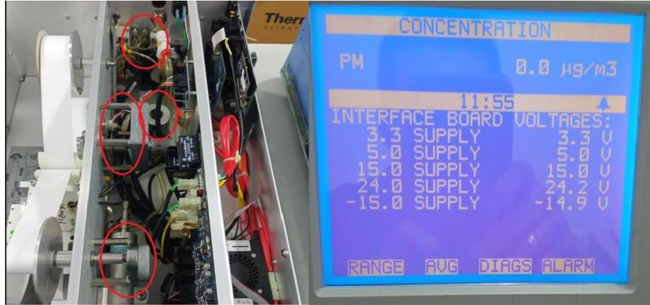
*Ilustración 3. Verificación de válvulas, motores y sistema mecánico. revisión de señales de voltaje.*
