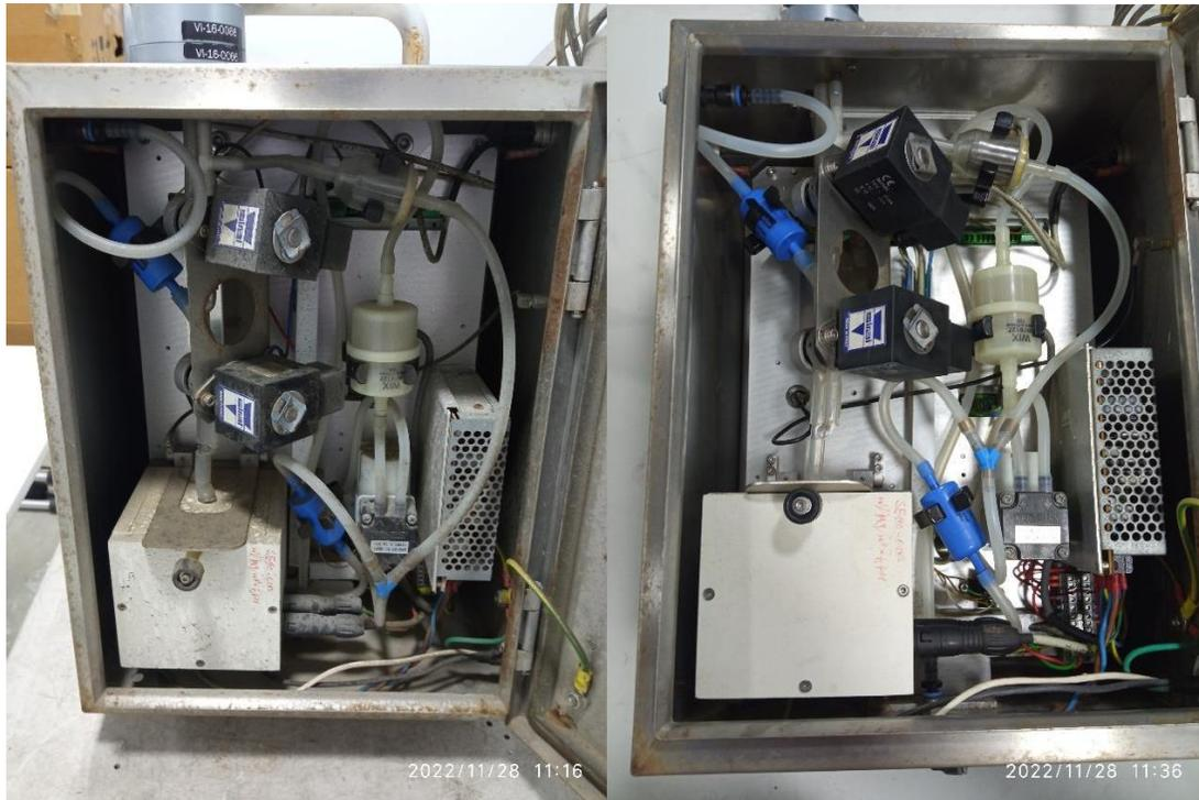
*Ilustración 106. Antes y después de la limpieza general del monitor de partículas.*
