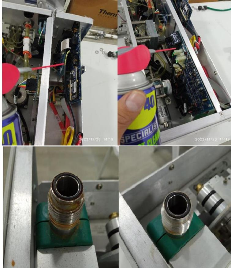
*Ilustración 13. Limpieza general, revisión y limpieza de tarjetas electrónicas. Antes y después de Limpieza de la boquilla.*
