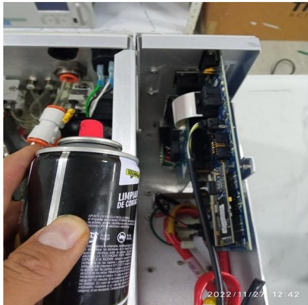
*Ilustración 129. Limpieza de tarjetas electrónicas.*
