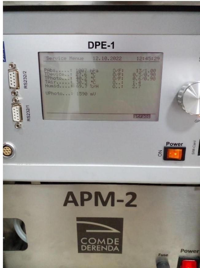
Ilustración 121. Verificación de los sensores internos, alarmas y sistemas electromecánicos.
