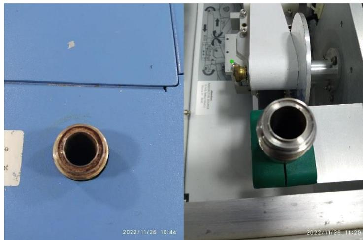
*Ilustración 2. Antes y Después de la limpieza de la boquilla.*
