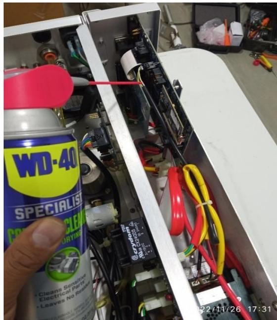
*Ilustración 47. Revisión general, limpieza de tarjetas.*
