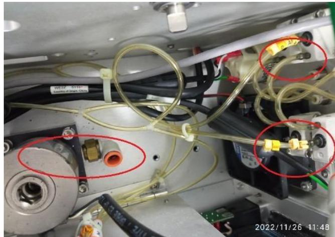
*Ilustración 30. Revisión de la válvula y del sistema neumático interno.*
