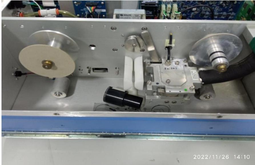
*Ilustración 15. Verificaciones de los motores y funcionalidad para la cinta filtro.*
