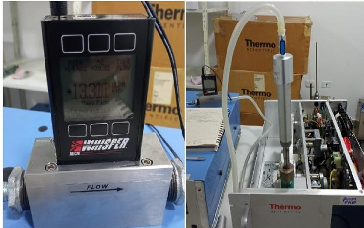
*Ilustración 5. Parámetro con falla en el detector másico, asociado al flujo observado en 13.3 LPM.*
