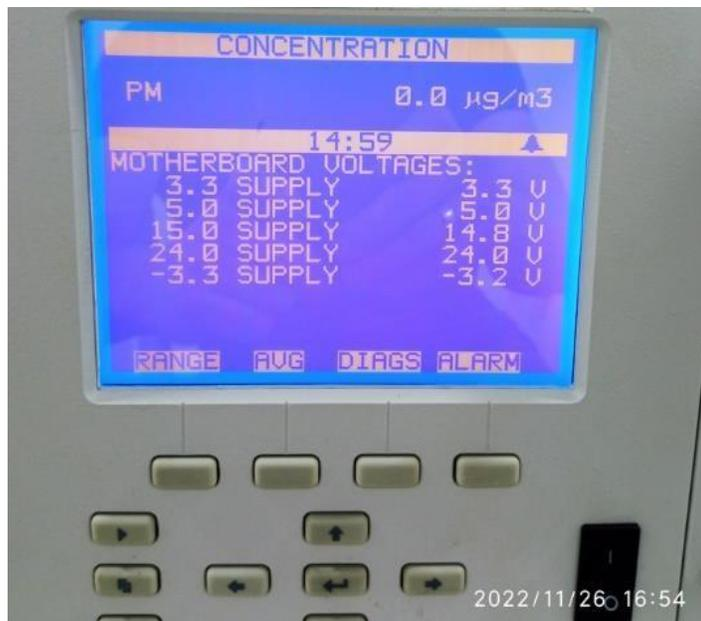
*Ilustración 40. Voltajes de la board. Se encuentran dentro de los niveles normales de operación.*
