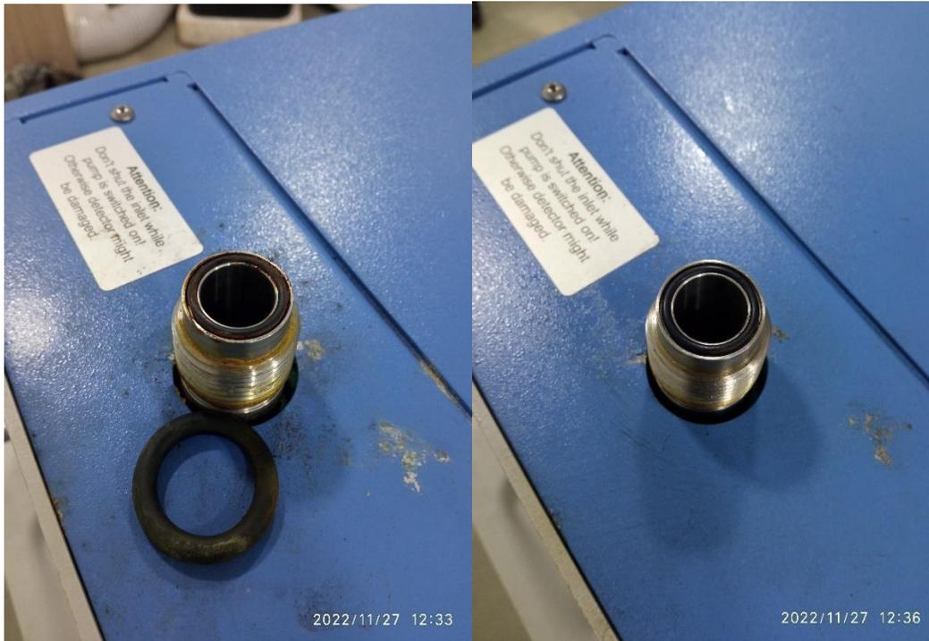
*Ilustración 130. Antes y después de la limpieza de la boquilla.*
