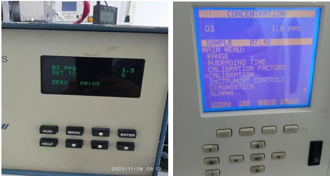
*Ilustración 143. Verificación y respuesta del analizador en el punto zero con material de referencia de O3.*
