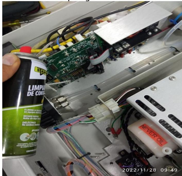
*Ilustración 88. Limpieza de tarjetas electrónicas y verificación de sistema neumático.*
