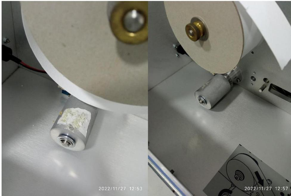
*Ilustración 132. Antes y después de la limpieza de las partes mecánicas.*
