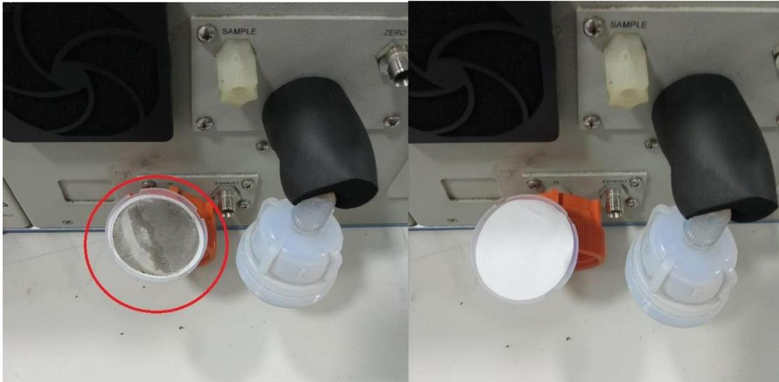
*Ilustración 139. Reemplazo del filtro de partículas.*
