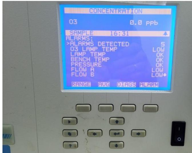
*Ilustración 80. Alarmas de flujo y desgaste de la lámpara UV.*
