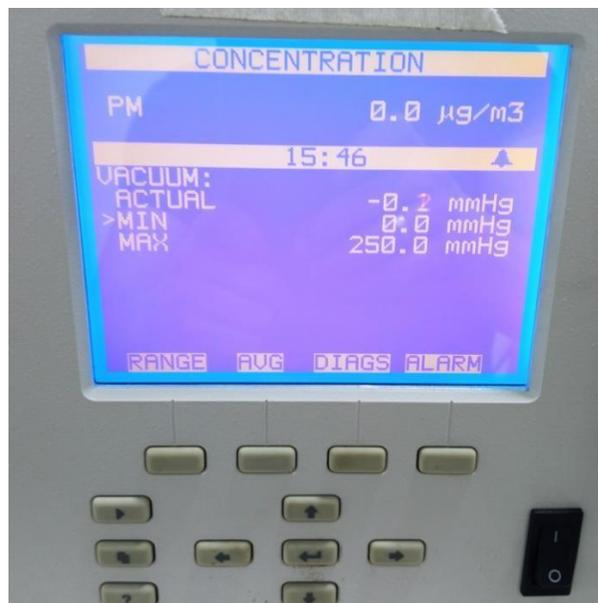
*Ilustración 52. Valores de vacío por fuera del rango normal de operación.*
