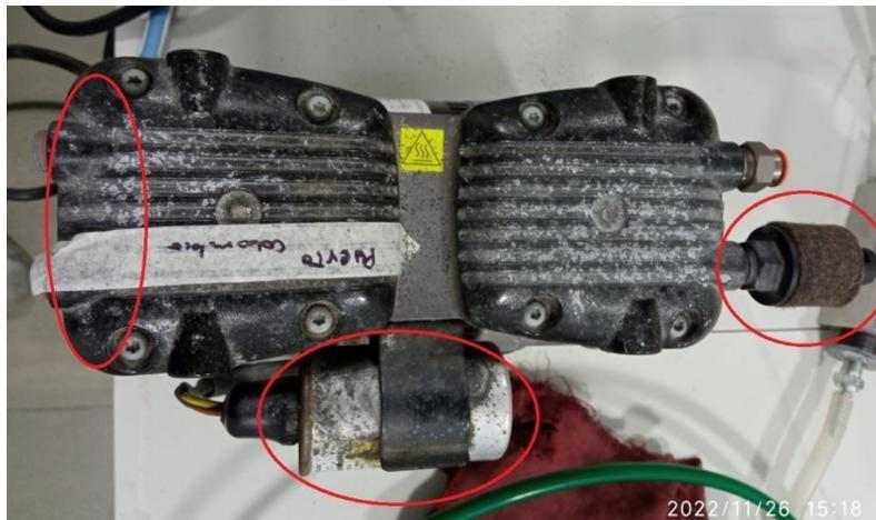
*Ilustración 19. Arranque de la bomba manualmente. Partes que se deben reemplazar de la bomba externa.*
