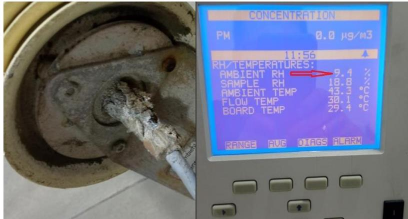
*Ilustración 7. Estación meteorológica asociada al equipo CM14521012. Se evidencia la sulfatación y se observa la falla en el sensor de humedad relativa.*
