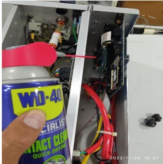
*Ilustración 39. Limpieza de tarjetas electrónicas.*
